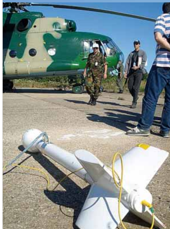
2006 年现场视察指导下演练，克罗地亚：在直升飞机下面拖曳的磁力仪。
