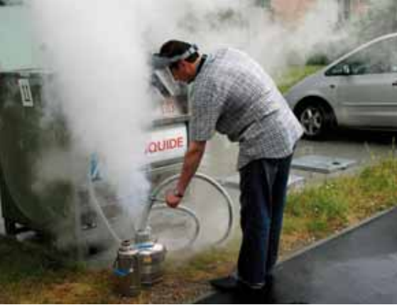
上图：往杜瓦瓶中注入液态氙，以冷却 ARIX-3F 系统。
