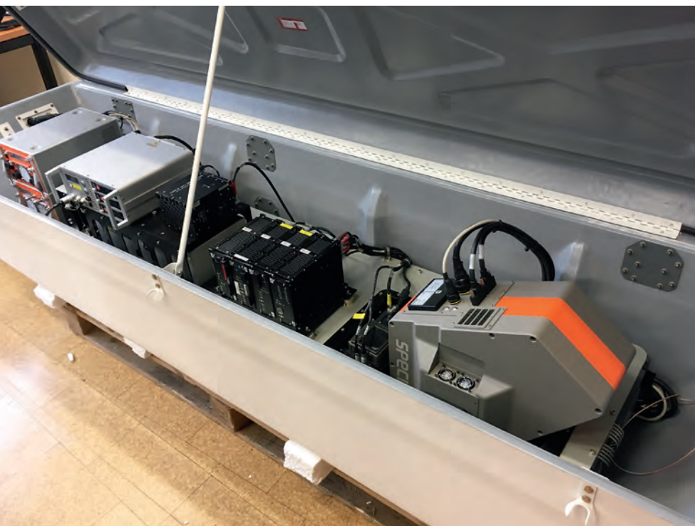
Arriba: Montura diseñada especialmente para el sistema aerotransportado de IIS multiespectrales (MSIR). A la izquierda: Componentes del sistema aerotransportado MSIR.
