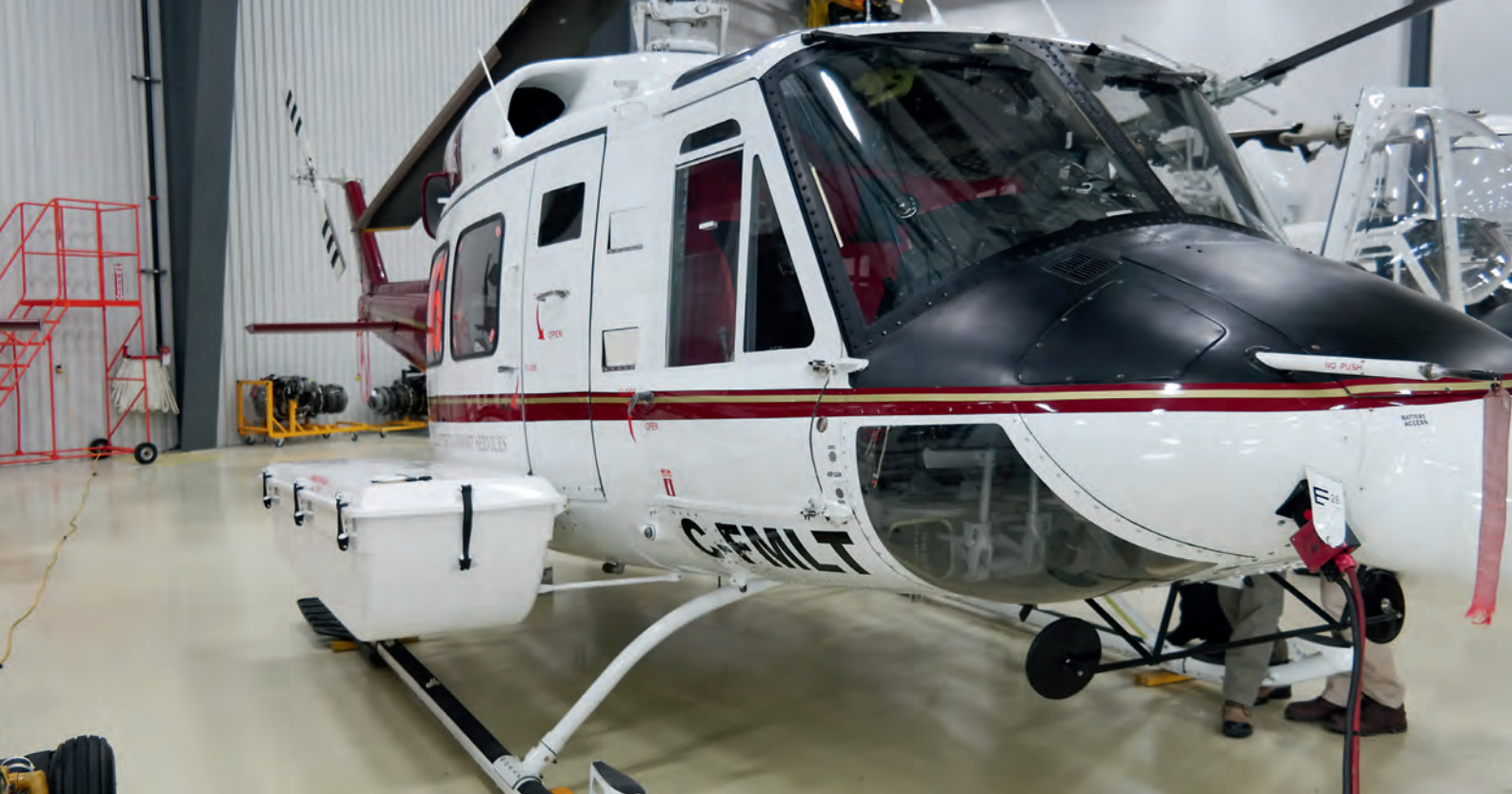
Arriba: Montura diseñada especialmente para el sistema aerotransportado de IIS multiespectrales (MSIR). A la izquierda: Componentes del sistema aerotransportado MSIR.
