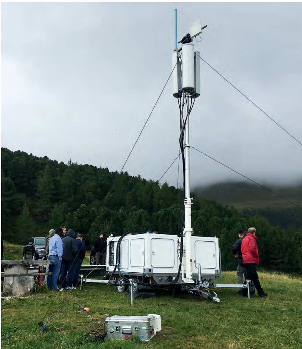
Ensayo sobre el terreno de equipo de telemetría para las IIS (Austria).
