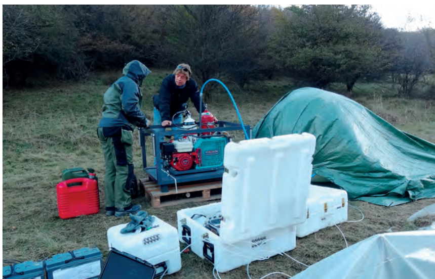
Mise à l'essai d'un échantillonneur intelligent conçu aux fins des inspections sur place (à titre de contribution en nature par les Etats-Unis) pendant un essai sur le terrain des techniques d'échantillonnage de gaz rares en sous-sol réalisé en Slovaquie en octobre 2012.
