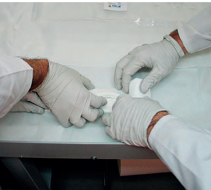
Laboratoire de radionucléides RL9, au Centre de recherche nucléaire de Soreq, à Yavne (Israël), homologué en 2012. Gauche : Echantillon du SSI obtenu au moyen d'un système de détection des gaz rares (échantillonneur/analyseur d'aérosols radioactifs); on l'enroule afin de l'insérer dans le disque cylindrique qui sera utilisé pour l'analyse spectrale et la prise de mesure. Droite : Vue de l'intérieur du laboratoire, avec le système de détection (en arrière-plan) et l'armoire qui abrite le système électronique et informatique du détecteur.
