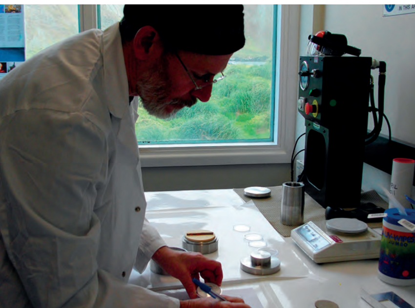
Station de surveillance des radionucléides RN7 de l'île Macquarie (Australie), certifiée en 2012. Gauche : Préparation du filtre une fois celui-ci retiré de l'échantillonneur d'air (droite) .
