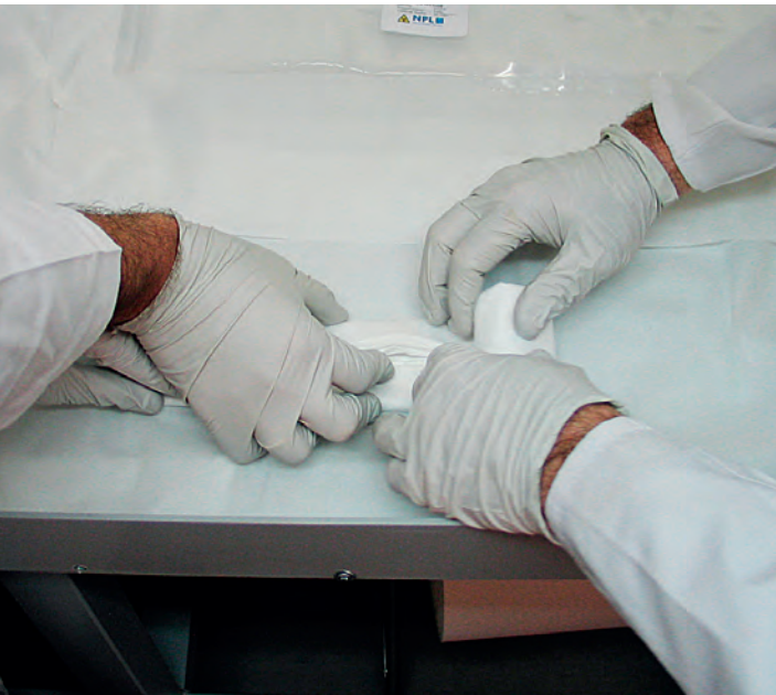
2012 年经过核证的以色列雅弗尼索雷克核研究中心放射性核素实验室 RL9。左侧：从在光谱分析和测量之前把为压缩起见而卷成圆柱盘的 RASA 惰性气体监测系统所得国际监测系统样品。右侧：显示探测系统（图片背面）的实验室内部以及装有探测器电子装置和计算机的搁物架。
