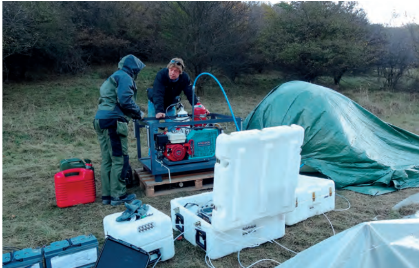
2012年10月在斯洛伐克对惰性气体底土取样技术进行现场测试期间为现场视察目的而开发的智能取样器（由美国作为实物捐赠提供）进行测试。
